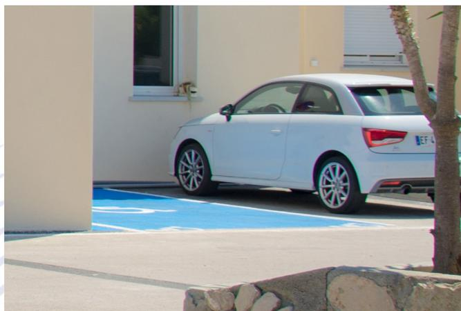
La largeur minimale des places adaptées doit être de 3.30m et leur longueur minimale est de 5m. Chaque place adaptée doit être signalée par un repérage au sol et une signalisation verticale. Il faut que la personne puisse descendre ou monter de la voiture en toute sécurité.
