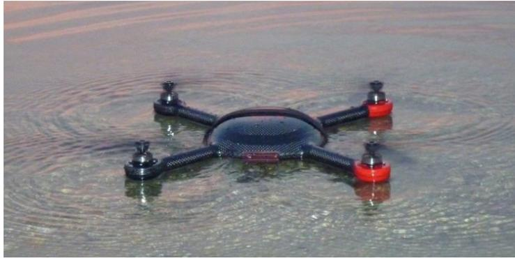
Drone quadricoptère water-proof pouvant être équipé d'une nacelle water-proof MAPIR.
